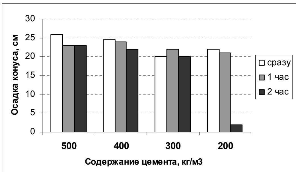
Рис.12. Подвижность бетонной смеси с золой-уноса в составе МФЗ, цементом ПЦ II/АШ-400 и СП
