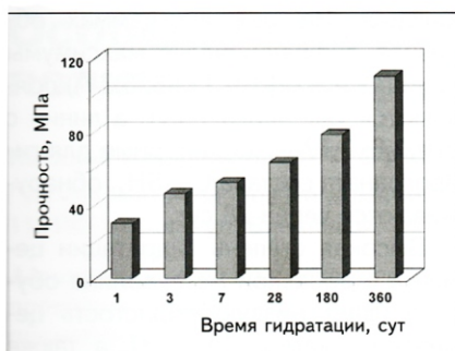
Рис. 1. Прочность цементного камня при гидратации смеси (CA + 15 % гранулированного шлака) в течение 1–360 сут
